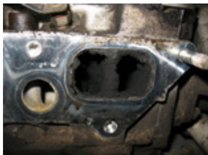
Zanieczyszczony kolektor ssący w silniku Diesla.
