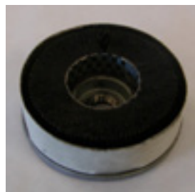
Zanieczyszczony filtr paliwa zanieczyszczeniami mikrobiologicznymi.
