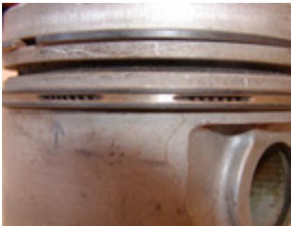
Nagar w rowkach pierścieni tłokowych.
