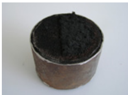
Zanieczyszczony filtr cząstek stałych (przekrój).
