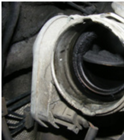
Proces rozpuszczania zanieczyszczeń w kolektorze ssącym w silniku.
