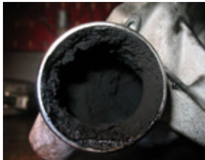
Zanieczyszczony kolektor ssący.
