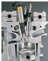
Fot. 2. Przekrój – silnik benzynowy DI BMW.
