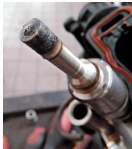
Zanieczyszczony lakiem i nagarem wtryskiwacz silnika benzynowego DI; przebieg: 110 tys. km.
