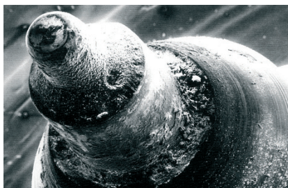
Zablokowany lakiem i nagarem wtryskiwacz otwórkowy Diesla.
