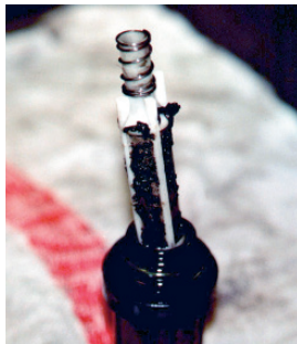
Mikroorganizmy w filtrze paliwowym silnika Diesla.
