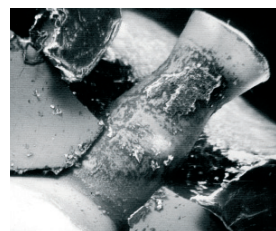
Zanieczyszczenia lakowe na końcówce wtryskiwacza benzynowego.
