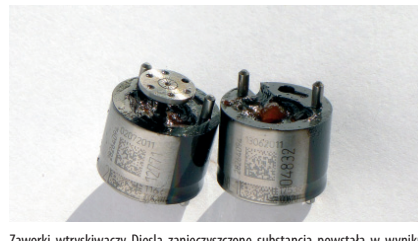
Zaworki wtryskiwacza Diesla zanieczyszczone substancją powstałą w wyniku saponifikacji estrów metylowych.
