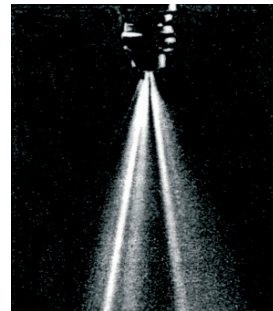
Żle działający wtryskiwacz, zablokowany zanieczyszczeniami.
