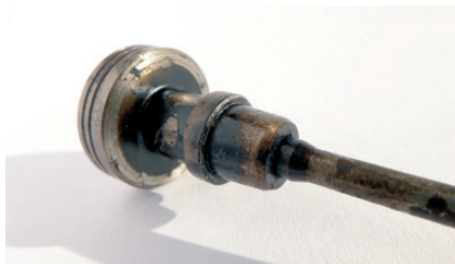
Zanieczyszczone elementy wtryskiwacza Diesla.
